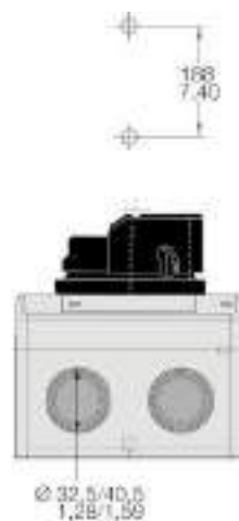
Cloisons défonçables en haut et en bas
