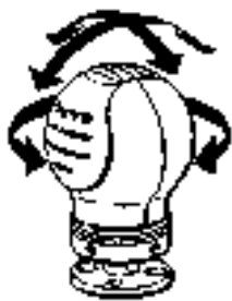
Montée sur rotule, la Safeball peut être pivotée et inclinée.
