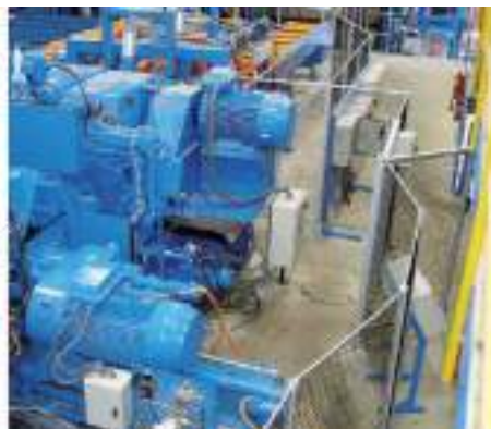
Quick-Guard E doté de peu d'éléments, facile à incliner jusqu'à 45 °
