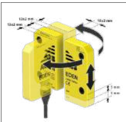
Montage flexible et distance de détection élevée
