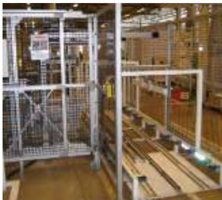
Quick-Guard Standard avec grillage
