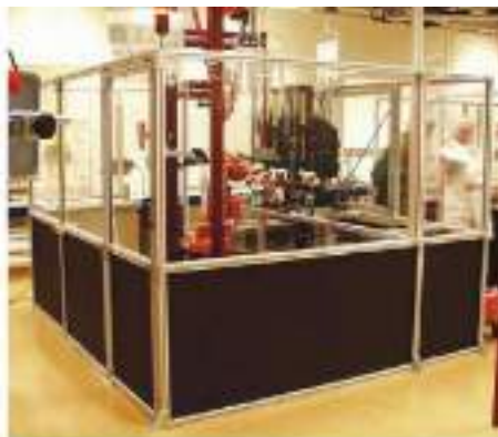
Quick-Guard Standard avec panneaux de remplissage en polycarbonate noirs et transparents utilisés pour les applications médicales
